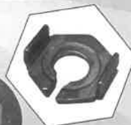
NAS3350に準じた振動試験 振動数 1,780rpm 加振ストローク 11mm インパクト ストローク 19mm
