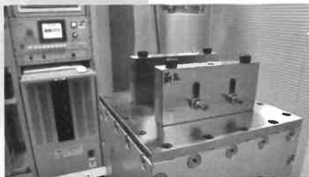
NAS3350に準じた振動試験 振動数 1,780rpm 加振ストローク 11mm インパクト ストローク 19mm
